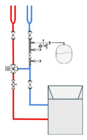
A gauche, raccorder le "Départ Solaire" (sortie des panneaux) et à droite le "Retour Solaire" (entrée dans les panneaux).
