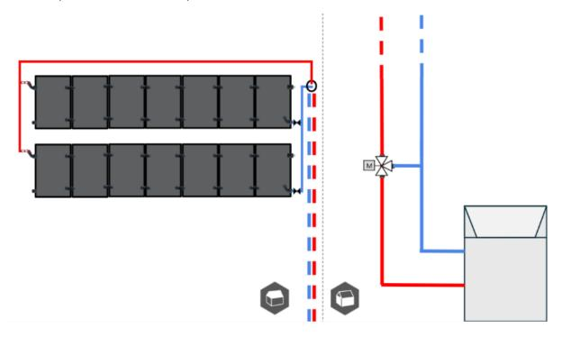
Le choix des vannes d'équilibrage dépend du taux de glycol acceptable, des températures d'utilisation (minimum et maximum) ainsi que des pertes de charge (voir paragraphe vannes d'équilibrage [30]).
