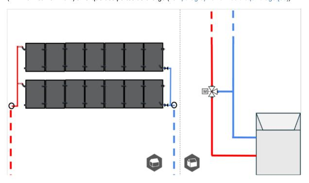
Il est possible de prévoir deux sorties distinctes en toiture ou une sortie commune pour les deux conduites (voir schéma ci-dessous) :
