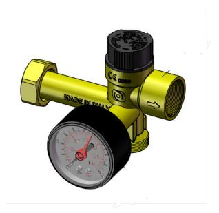
Le manomètre visuel est utile pour contrôler la pression notamment lors du remplissage et la purge du circuit hydraulique des panneaux solaires. Celui intégré à la station solarothermique Dualsun affiche la pression comprise entre 0 et 10 bar.
