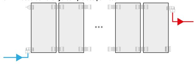
Tous les sens de raccordement hydraulique peuvent fonctionner avec les panneaux Dualsun SPRING MAX. En revanche, pour optimiser la production thermique nous imposons un branchement dit en Z : entrée en bas de panneau et sortie en haut sur le côté opposé.
