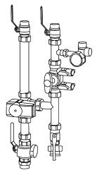
La station solaire solarothermique permet de faciliter l'installation d'un système Dualsun MAX en incluant tous les éléments hydrauliques nécessaires à la mise en place et la maintenance du circuit primaire de la Pompe à chaleur.
