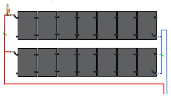
L'ensemble des points hauts des champs de panneaux doit être équipé de purgeurs d'air.
