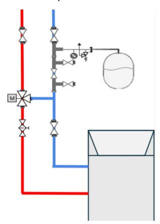
A gauche, raccorder le "Départ Solaire" (sortie des panneaux) et à droite le "Retour Solaire" (entrée dans les panneaux).
